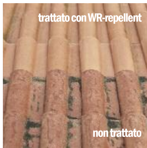
Test di invecchiamento di 36 mesi su tegole in cotto. (Centro Studi e Ricerche Gattocel)
